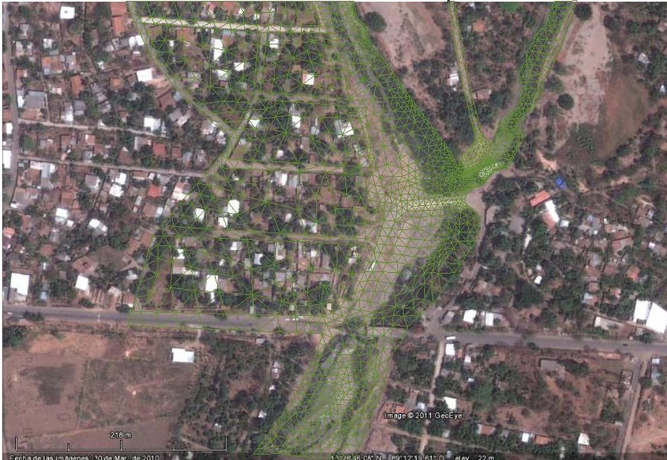
Modelo numérico – Malla de elementos finitos
