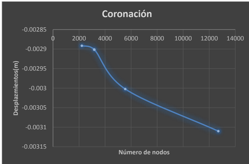
Figura 41. Convergencia de los desplazamientos en la coronación.
