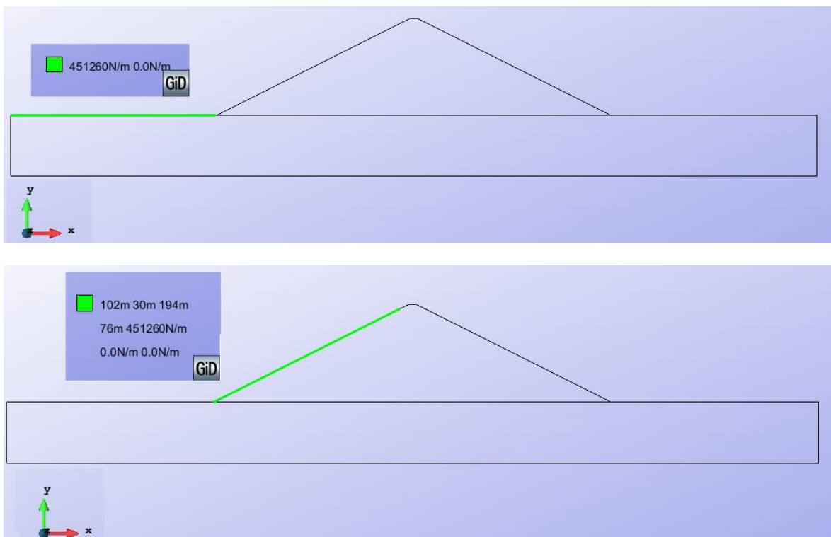
Ilustración 5. Geometrías que muestran las cargas hidrostáticas en el terreno y la presa
